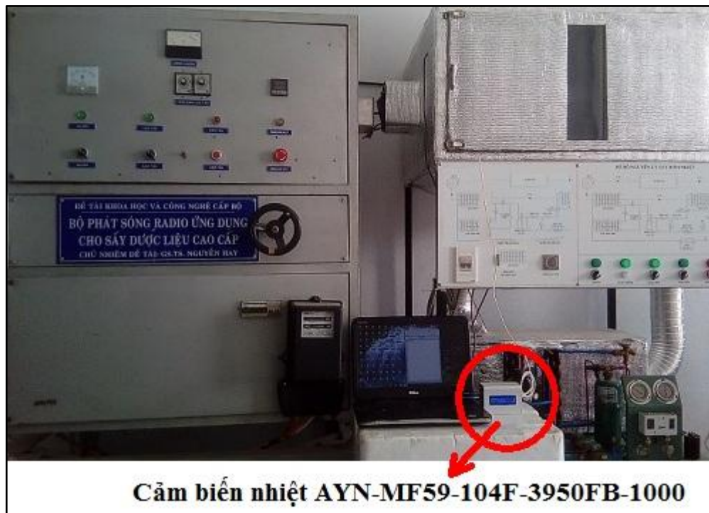
Hình PL1.5. Cảm biến nhiệt độ đo nhiệt độ VLS (AYN-MF59-104F-3950FB-1000)
