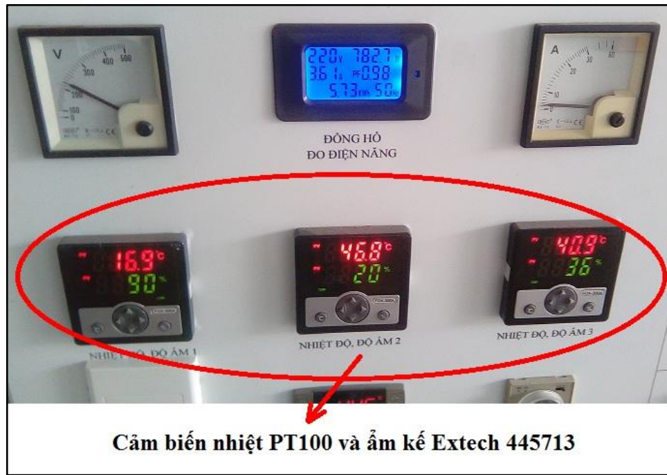
Hình PL1.1. Thiết bị đo nhiệt độ (cảm biến nhiệt PT100) và ẩm độ TNS (ẩm kế Extech 445713)
